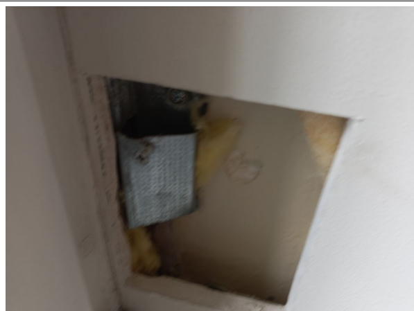
Prélèvement - P134 : BATIMENT 1 / R+1 / SALLE REUNION - Enduit- (Absence d'amiante)
