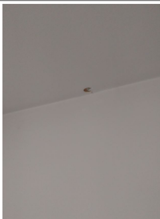
Prélèvement - P91 : BATIMENT 1 / R+3 / ESC 1 - Bande de plaque de plâtre- (Absence d'amiante)
