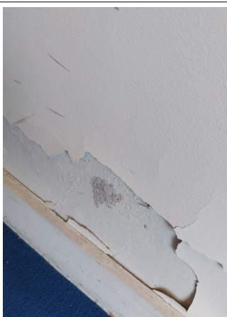
Prélèvement - P4 : BATIMENT 1 / RDC / SALLE LECTURE - Enduit- (Absence d'amiante)
