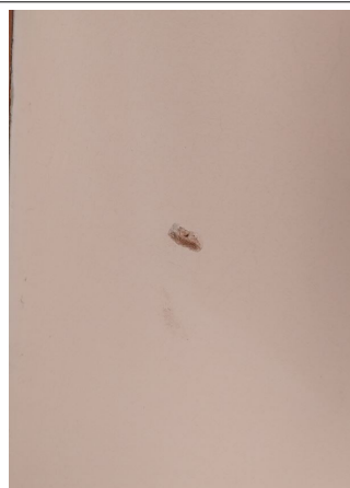
Prélèvement - P2 : BATIMENT 1 / RDC / SALLE LECTURE - Enduit- (Absence d'amiante)
