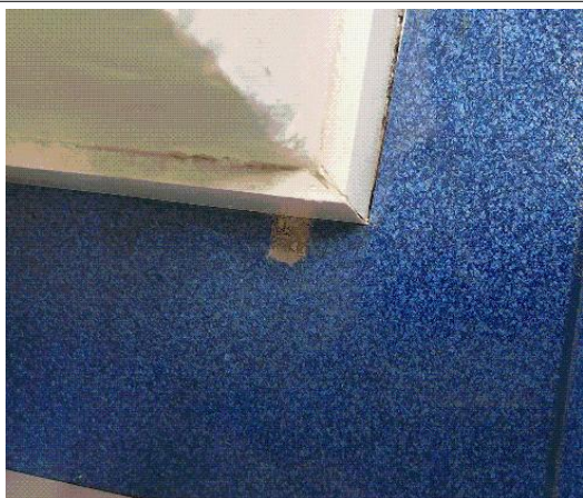
Prélèvement - P51 : BATIMENT 1 / R+1 / ARCHIVES 1 - Colle- (Absence d'amiante)
