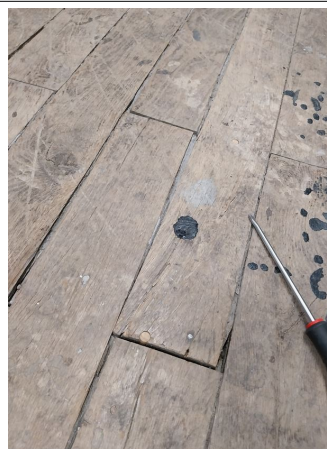
Prélèvement - P86 : BATIMENT 1 / R+2 / ARCHIVES 2 - Colle bitumineuse- (Absence d'amiante)
