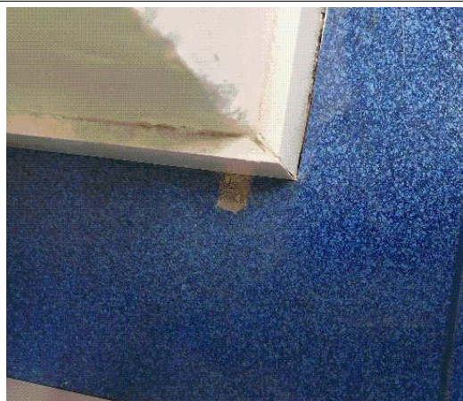
Prélèvement - P68 : BATIMENT 1 / R+1 / BUREAU 18 - Colle- (Absence d'amiante)
