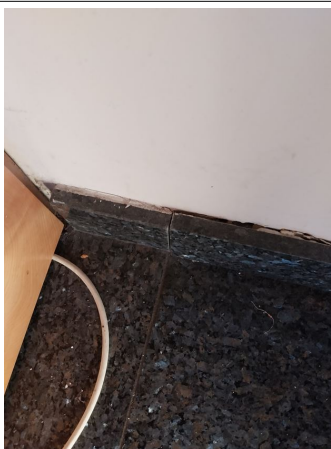
Prélèvement - P19 : BATIMENT 1 / RDC / SALLE DETENTE - Colle de plinthe- (Absence d'amiante)
