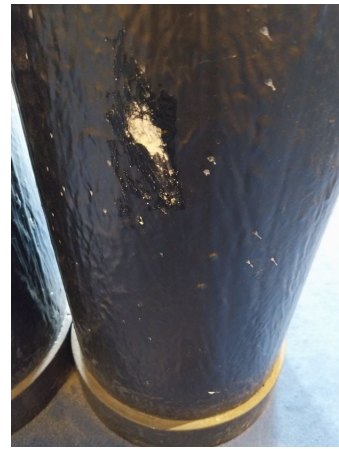
Prélèvement - P8 : BATIMENT 1 / RDC / SALLE LECTURE - Enduit- (Absence d'amiante)
