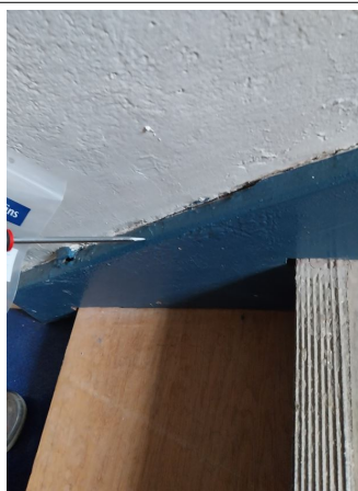
Prélèvement - P72 : BATIMENT 1 / R+1 / ESC 2 - Peinture- (Présence d'amiante)
