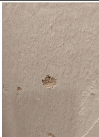
Prélèvement - P142 : BATIMENT 1 / R+1 / LOCAL TECHNIQUE - Enduit- (Absence d'amiante)
