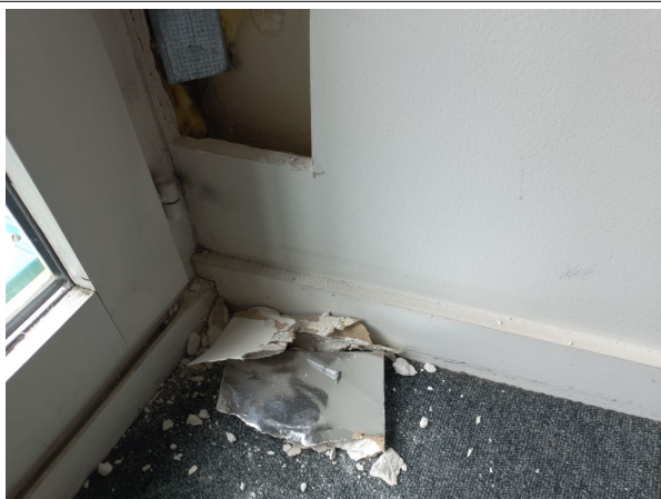
Prélèvement - P133 : BATIMENT 1 / R+1 / SALLE REUNION - Bande de plaque de plâtre- (Absence d'amiante)
