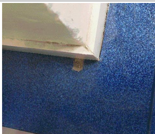
Prélèvement - P34 : BATIMENT 1 / RDC / CIRC 01 - Colle- (Absence d'amiante)
