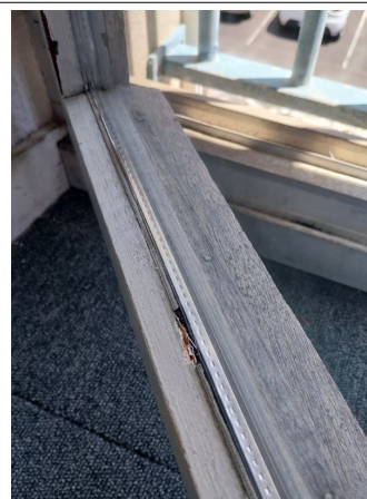
Prélèvement - P54 : BATIMENT 1 / R+1 / ARCHIVES 1 - Mastic - (Absence d'amiante)
