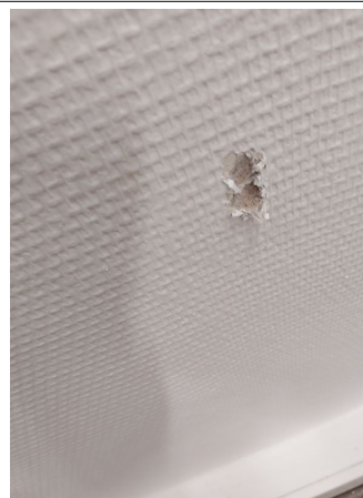
Prélèvement - P38 : BATIMENT 1 / RDC / ARCHIVES - Enduit- (Absence d'amiante)
